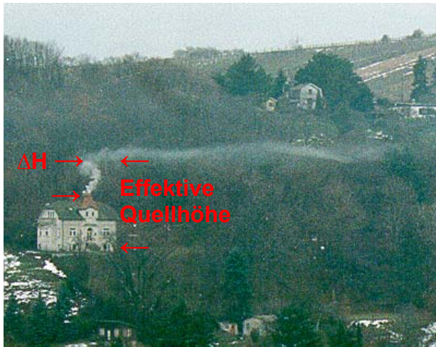
Abbildung 2.8.1.1: Ausbreitung einer Abgasfahne. \Delta H ist die Schornsteinüberhöhung (siehe Text).
