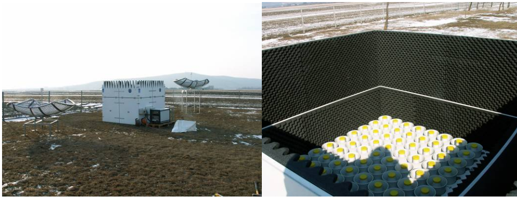
Abbildung 2.8.4.4: Kombination von Akustikradar und konventionellem Radar (Sodar-RASS). Links: Akustikradar mit Schallschutz (Mitte), Sendeantenne (rechts vom Schallschutz) und Empfangsantenne (links) des Radars. Rechts: Lautsprecher des Akustikradars mit Schallschutz
