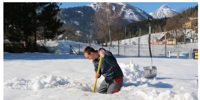
Schneelastmessung durch Techniker des KS Kärnten in Kötschach-Mauthen
