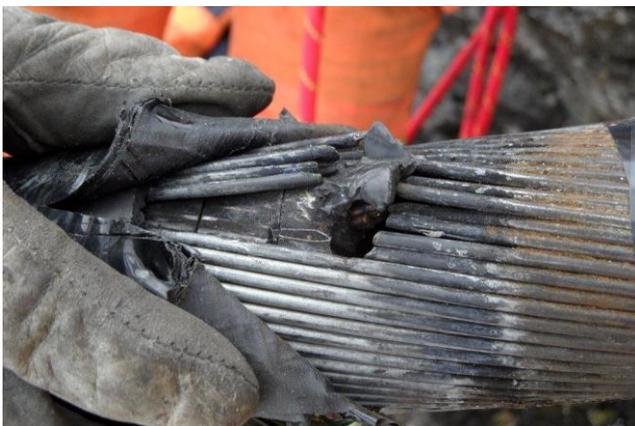
Der Schaden am 20 kV-Kabel – vermutlich kam es durch permanente Drehbewegung über 35 Jahre hinweg im Kabel zu einem Kurzschluss
