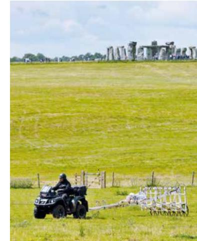
Im Projekt wird die Umgebung von Stonehenge flächendeckend mit geophysikalischen Methoden wie Bodenradar und Magnetometer vermessen
