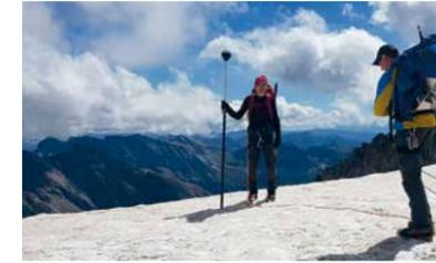
Glaziologen der ZAMG mit einem differentiellen GPS, das Messungen der Schneepiegel im Zentimeterbereich ermöglicht
