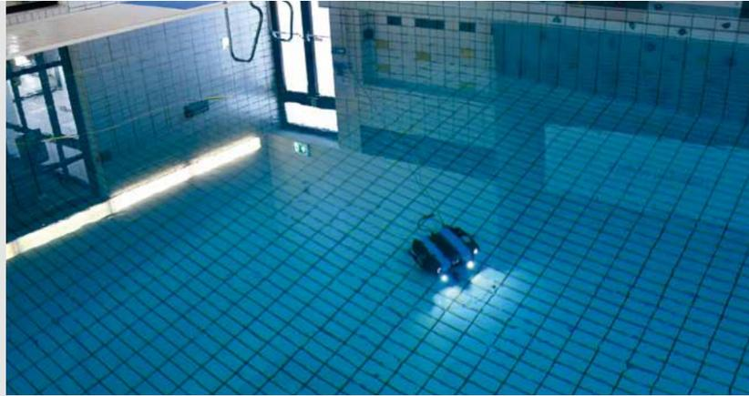
Im Februar 2020 teste die ZAMG im Hallenbad Neunkirchen einen neuen Tauchroboter. Er kann bis in Tauchtiefen von 200 Meter betrieben werden und besitzt eine 4K UHD Kamera und einen Greifarm, um Proben vom Grund zu nehmen. Eine Anwendung des
