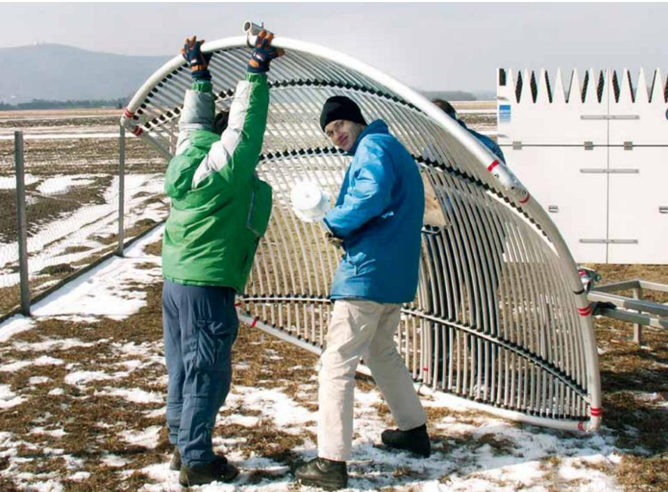
Aufbau eines Messgeräts (SODAR-RASS) um mit Schall- und Radarwellen bodennahe Luftschichten zu analysieren
