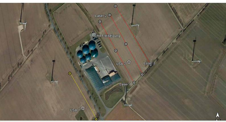
Biogasanlage mit Messaufbau zum Bestimmen der Freisetzung von Methan Biogas plant with measuring set-up for determining the release of methane
