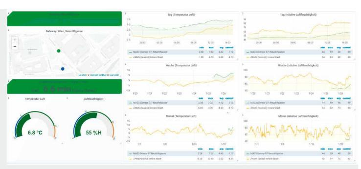
Viele Anwendungen enthalten auch meteorologische Sensoren. Hier Messdaten eines Steuerungskastens der Stadt Wien in der Neustiftgasse. Many applications also include meteorological sensors. Here is the measurement data from a control box of the city of Vienna in Neustiftgasse.
