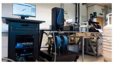
Im neuen Vibrationsmagnetometer werden zum Beispiel Sedimente bei –143 °C gemessen. In the new vibration magnetometer, for example, sediments are measured at -143 °C.
