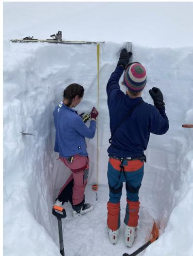
**Bestimmung der Dichte und Temperatur der Schneedecke in einem Schneeschacht.** Quelle: GeoSphere Austria/Neureiter [->volle Auflösung](#)
