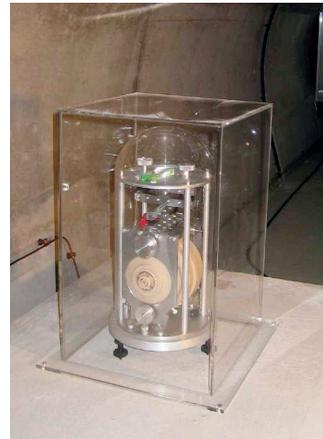
Moderne Erfassung des Erdmagnetfeldes vom Typ: GEM didD System mit Overhauser Magnetometer
