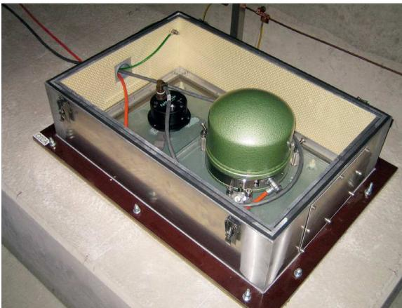
Erdbebenmessstation: Seismometer vom Typ Streckeisen (grün) und Strong-motion Sensor für die Aufzeichnung starker Bodenbewegungen (schwarz)
