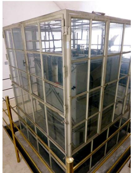
Vertikalseismograph von Wiechert
