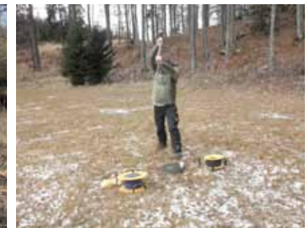
Hammerschlagseismik am Trafelberg beim Conrad Observatorium in Niederösterreich.
