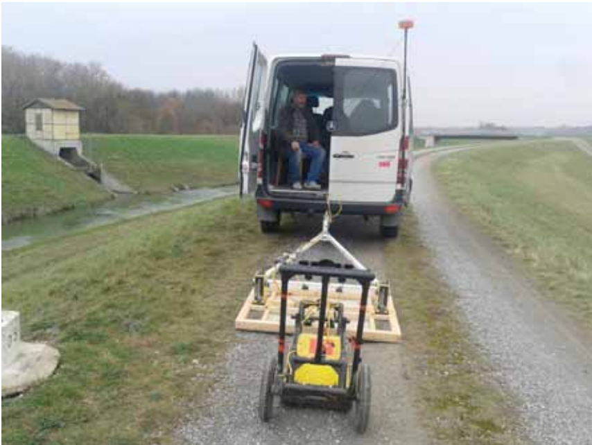
Untersuchung am Marchfelddamm mit Georadar
