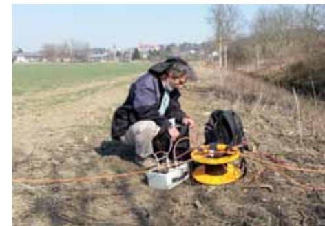
Geoelektrik in Hollabrunn
