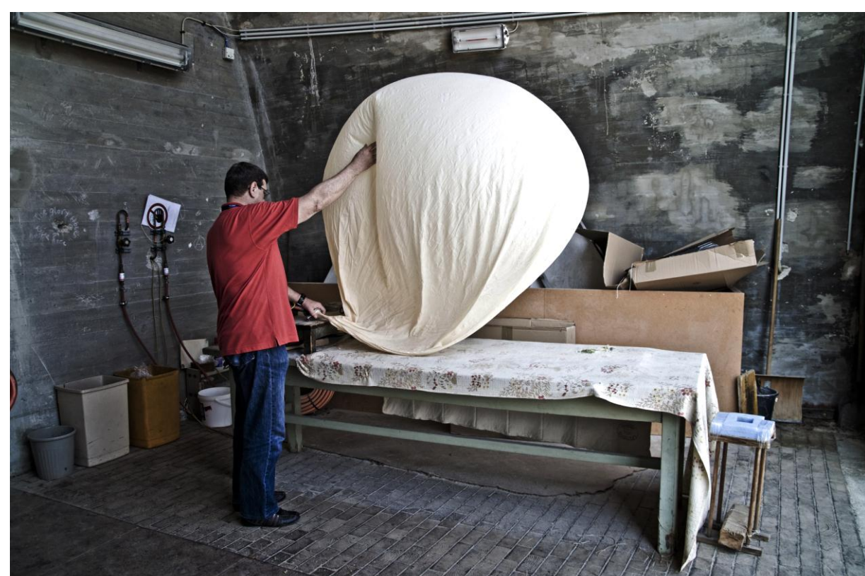
Der Ballon besteht aus Gummi (Latex) und hat ein Eigengewicht von etwa 1200 Gramm. Gefüllt wird er mit Helium oder Wasserstoff.
