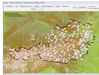
Für das Wettermonitoring ist eine rasche und praktikable Übersicht über Wetterdaten unerlässlich. Der in der ZAMG-Vorhersageabteilung entwickelte TAWES-Viewer ist dafür ein hilfreiches Werkzeug, das im 10-Minuten-Takt die einzelnen Wetterparameter der insgesamt 250 österreichweiten Stationen abbildet. ■
