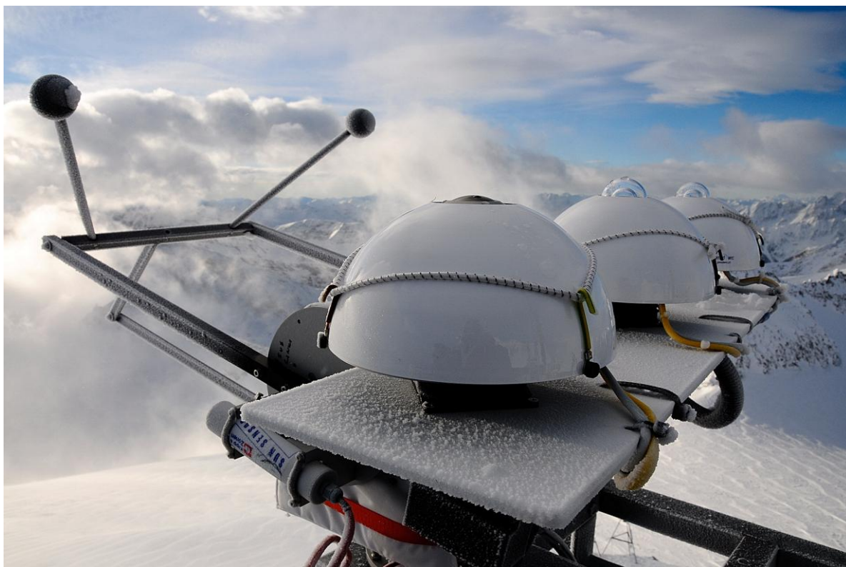
Der neue Suntracker misst langwellige Gegenstrahlung sowie kurzwellige direkte und diffuse Strahlung (die Abschattungsplättchen werden im Tages- und Jahresverlauf nachgeführt) Foto G. Weyss, 14.1.2011
