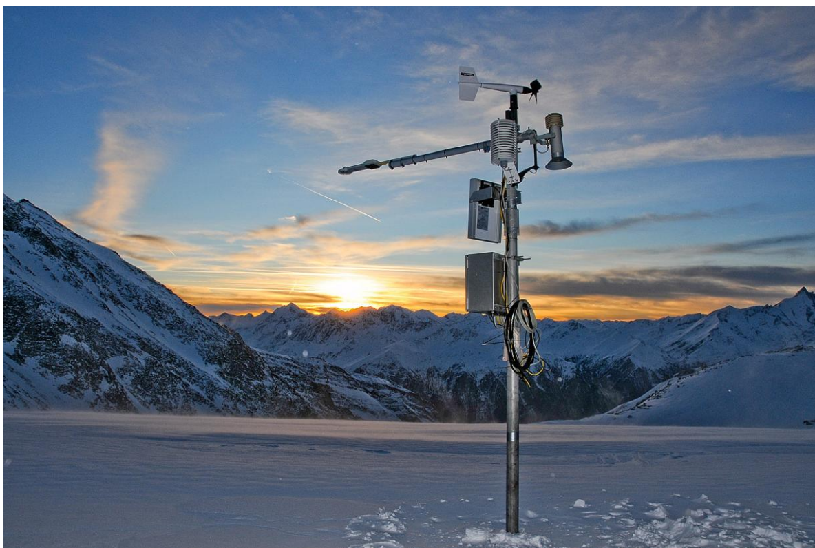
Die automatische Wetterstation auf dem Kleinfleißkees
