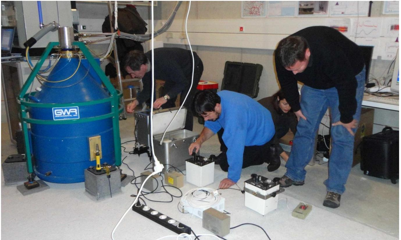
Die Wissenschaftler beim Aufbau der Gravimeter am Meßsockel. Links im Bild das Gezeitengravimeter der ZAMG. Copyright: Norbert Blaumoser
