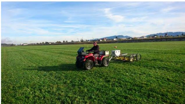
Abbildung 1: Einsatz des motorisierten Bodenradarmesssystems Sensor&Software SPIDAR.
