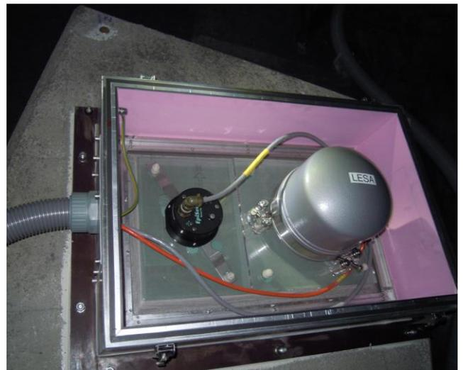
Seismische Sensoren isoliert auf Glasplatte montiert, geschützt in Aluminiumbox
