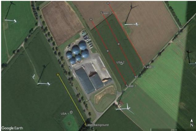
Abb. 1: Biogasanlage in Apensen, Deutschland. Dargestellt sind die Pfade der Abwind-Lasermessungen (rote Linien), Hintergrund-Lasermessung (gelbe Linie) und die Position der Ultraschallanemometer („USA“, weiße Sterne). Quelle: Google Earth
