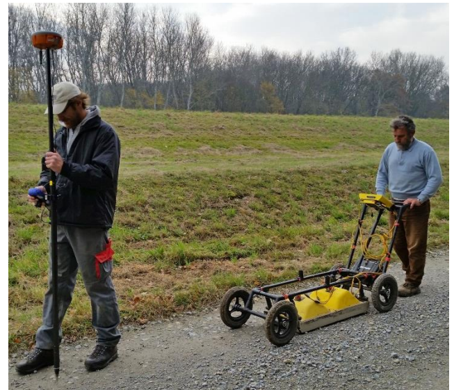
Manuelle Messung mit Georadar entlang eines Damms Quelle: Klaus Löcker
