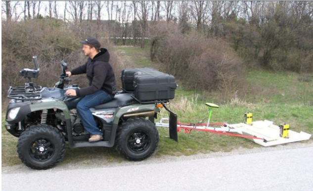
Motorisierte Georadarvermessung Quelle: Klaus Löcker
