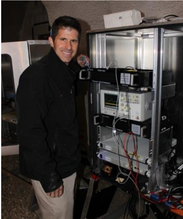
Mike Wilson von GEM Systems bei der Konfigurierung der Elektronikkomponenten und dem Systemtest für das Supergradiometer. Quelle: ZAMG
