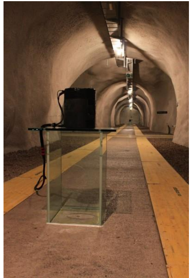
Ein Kaliumsensors auf dem unmagnetischen Glassockel im Conrad Observatorium. Quelle: ZAMG
