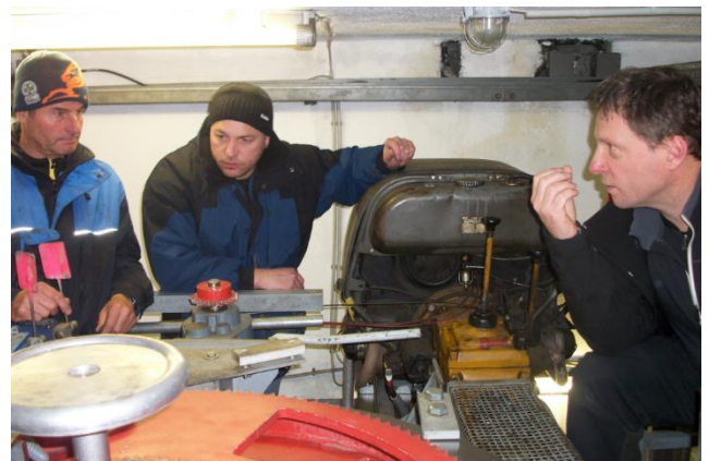
Intensive Seilbahneinheit: Händisches Umschalten auf Notbetrieb
