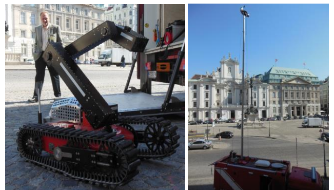
Präsentation modernster Messeinrichtungen des Schadstoffzugs der Wiener Feuerwehr: Fernerkundungsmessung für toxische Gase (z.B. Überwachung bei Großveranstaltungen) und ein ferngesteuertes Fahrzeug zur Gaskondensationsmessung bei Giftgasfreisetzungen Quelle: Gabriele Rau
